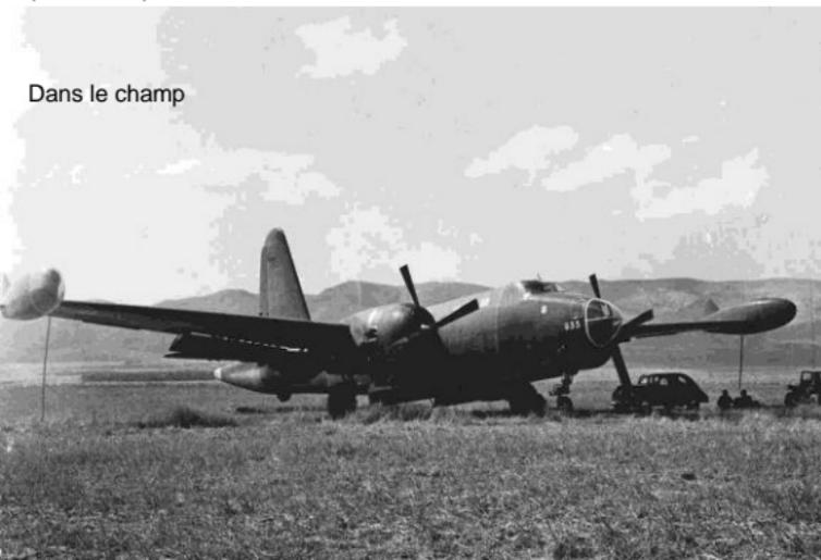
Le 4 septembre 1963 le *Neptune* 134655 de la 21F décolle de Malte vers Lartigue avec 13 hommes à bord. Après 5 heures de vol, le pilote déconnecte le pilote automatique et reprend les commandes. Le compensateur de profondeur se déroule à fond à cabrer (une électrovalve est restée collée ouverte). L'avion cabre et perd de la vitesse à la limite du décrochage.
